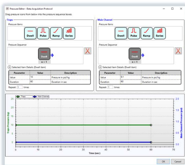
Figura AI- 3. Interfaz del editor de presión. El editor de presión permite modificar las presiones ejercidas en el canal principal y a través de las trampas para el correcto flujo de fluidos y succión sobre las células.
